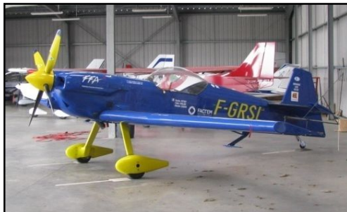
CAP 10 biplace F-CNCV. 180 CV. CAP 231 monoplace F-GRSL. 320 CV.
